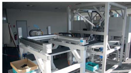
Etude et réalisation d'une machine spéciale pour l'assemblage de galerie aluminium pour véhicule utilitaire.
