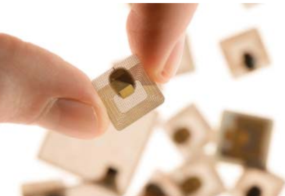
Une puce intelligente multi-usages (RFID)
